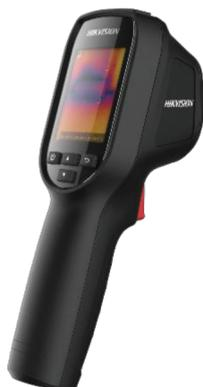
Ručna termografska kamera opremljena je termičkim detektorom rezolucije 160x120px koja prikazuje temperaturu na ugrađenom ekranu. Pomaže da se brzo otkriju osobe sa visokom temperaturom
